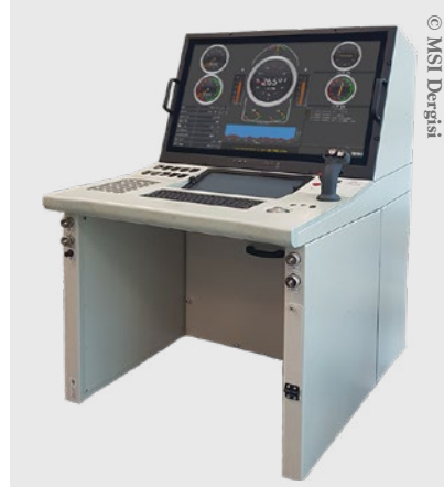
YALTES, yeni nesil konsollarında, 30 inçlik geniş ekranlar kullanıyor. Böylece, radar ya da elektro-optik algılayıcılardan gelen görüntülerle görev yönetim uygulamaları, aynı ekranda gösterilebiliyor.
