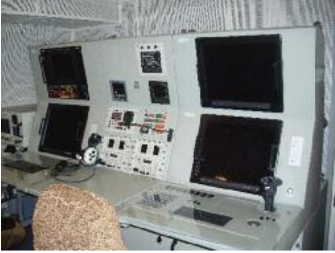
Yaltes, Kasım '08 tarihinde Havelsan ile imzalanan anlaşma altında Yeni Tip Karakol Botları'nın Savaş Harekat Merkezi [SHM]'nde kullanılmak üzere bot üzerindeki EO Sistemi ve Sonar Sistemi'ni kontrol edebilecek birer adet operatör konsolu ile yardımcı birimlerin monte edildiği bir konsol arabirimi tasarlamıştır [Fotoğraf: M. DEMİRKOL/S&H].
